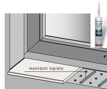
Parapety se v tomto případě osazují pomocí trvale elastického montážního lepidla na rovný, vyzrálý podklad. Lepidlo nanášejte v proužcích výšky 5 - 8 mm ve vzdálenosti cca. 10 cm.
