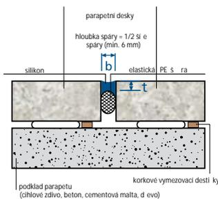
**Hloubka spáry = 1/2 šířky spáry (min. 6 mm).**
