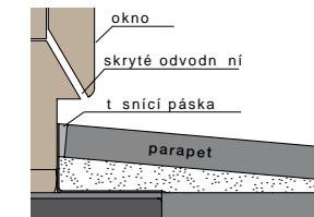
U oken se skrytým odvodn ním lze ut snit spáru mezi parapetem a podokenní lištou, mezi parapetem a spodní hranou rámu okna musí z stat mezera min. 5 mm.
