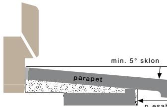
Vnější parapety doporučujeme osazovat ve sklonu 5°.
