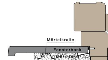
Na spodní hranu parapetu se připevní pomocí šroub montážní kotvy a parapet se osadí do maltového lože (cementová malta).
