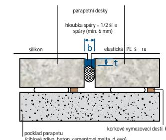
Hloubka spáry = 1/2 ší e spáry (min. 6 mm).
