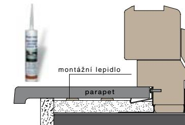
Parapet se v tomto případě osazuje pomocí trvale elastickeho montážního lepidla, naneseného ve tvaru housenky na rovný, vyzrálý podklad.
